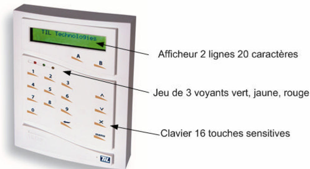
Figure 2 : Vue du clavier de commande de la centrale Tillys
